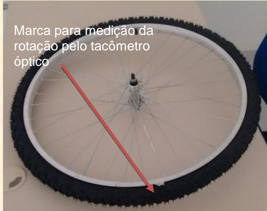
Figura 69: Experiência 04. Roda da bicicleta com detalhe da película reflexiva para medição da rotação pelo tacômetro óptico
