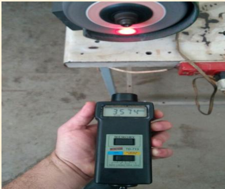
Figura 67 : Experiência 04. Medida da velocidade angular, 3574rpm , do reboło de aceleração da roda da bicicleta, com o tacômetro óptico
