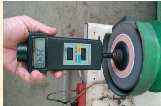
Figura 68: Experiência 04. Detalhe da medida de velocidade angular, 3546 rpm , do reboło de aceleração da roda de bicicleta, com o tacômetro por contato.
