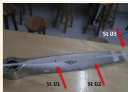
Figura 33: Experiência 01 - Pá da hélice já dividida em 03 estações de igual comprimento.
