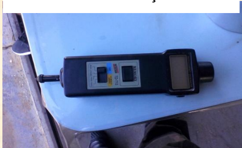
Figura 61 : Experiência 04. Tacômetro óptico utilizado para medir a rotação
