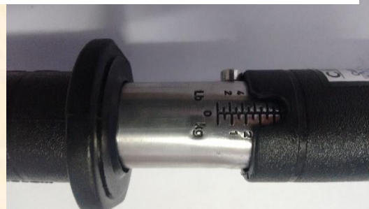
Figura 46 : Faixa de medição disponível na balança de peixeiro de 1 à 11kgf
