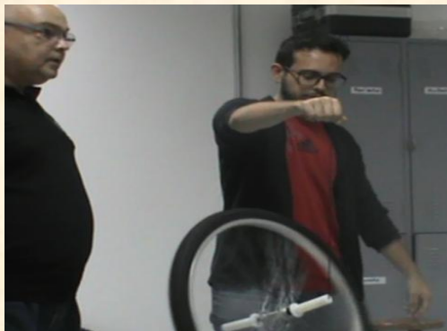
Figura 81: Experiência 05. Demonstração (1) da precessão giroscópica em razão do torque produzido pela decomposição do momento angular
