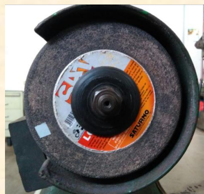
Figura 66: Experiência 04. Detalhe da película reflexiva que irá ser utilizada para a medição da rpm com o tacômetro óptico
