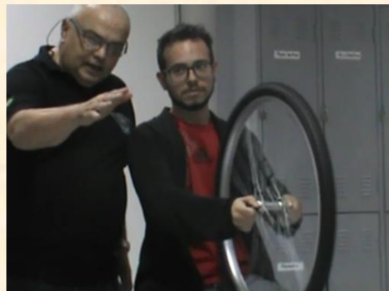
Figura 76: Experiência 04. Aplicado rotação na roda de bicicleta, ou seja, a velocidade angular é de 113,9 \text{ rpm}
