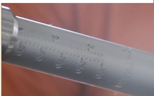
Figura 47 : Experiência 02. Calibrando o torquímetro par a 1 kgf.m
