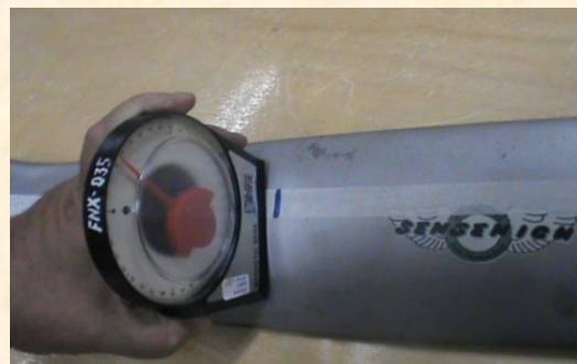
Figura 35: Experiência 01 - Medição do grau de incidência da pá em cada uma das estações usando o protactor.
